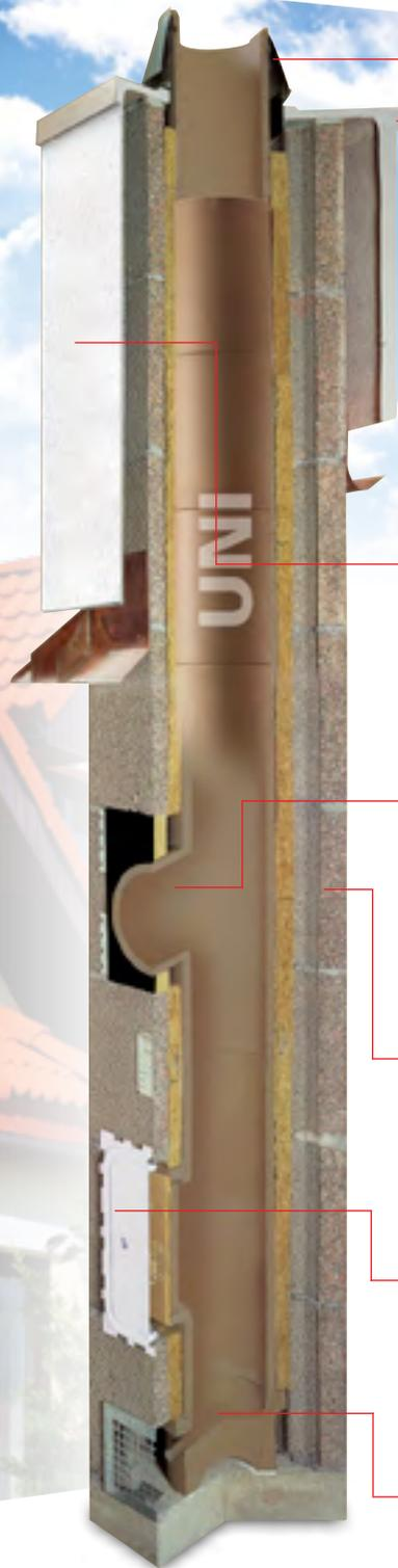
Конструкция конуса обеспечивает отвод влаги и высоких температур от внутренней изоляции дымоходной системы.
